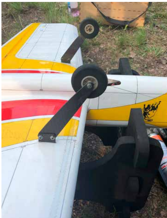
Landningsstället på Christoph Holtermanns modell hade en intressant konstruktionslösning bestående av löstagbara ben av kolfiber.
