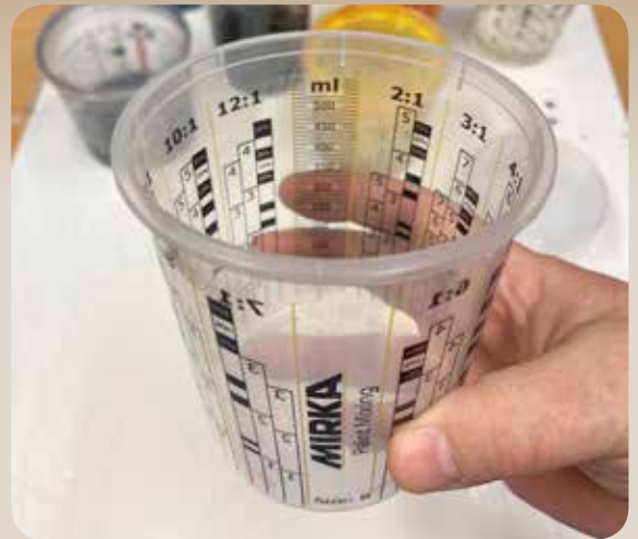
Blandningskoppen har en praktisk invändig gradering.
