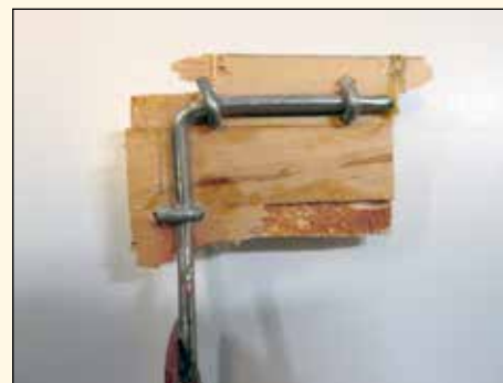
Med denna Infästning fjädrade huvudstället minimalt.
