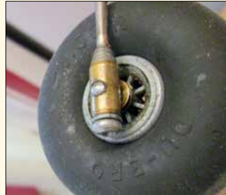
Nosstället var av 2,5 mm pianotråd utformat som en gaffel, vilket gör att hjulet inte ändrar riktning när det rullar efter många landningar. Hjulaxeln är fästad med ett litet rör och fastskruvad med M3 skruv.
