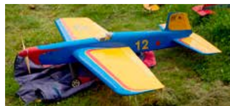
Harrys Blåmann, elmodell med en Axi 2826/12, Jeti Spin 66-regulator och en Brodak Timer.
